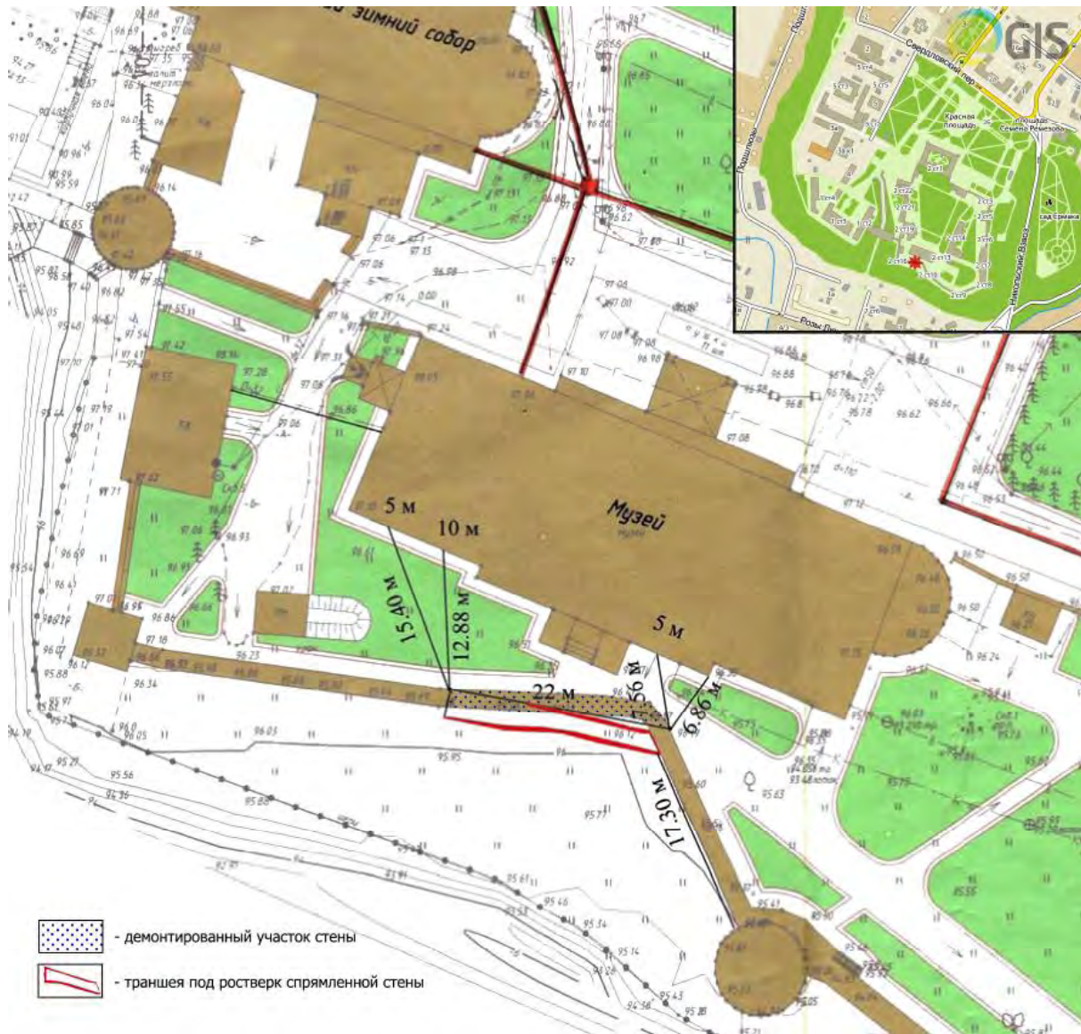
Ил. 1. ПМА, 2GIS. Схема расположения участка работ в Тобольском кремле в 2006 г.
