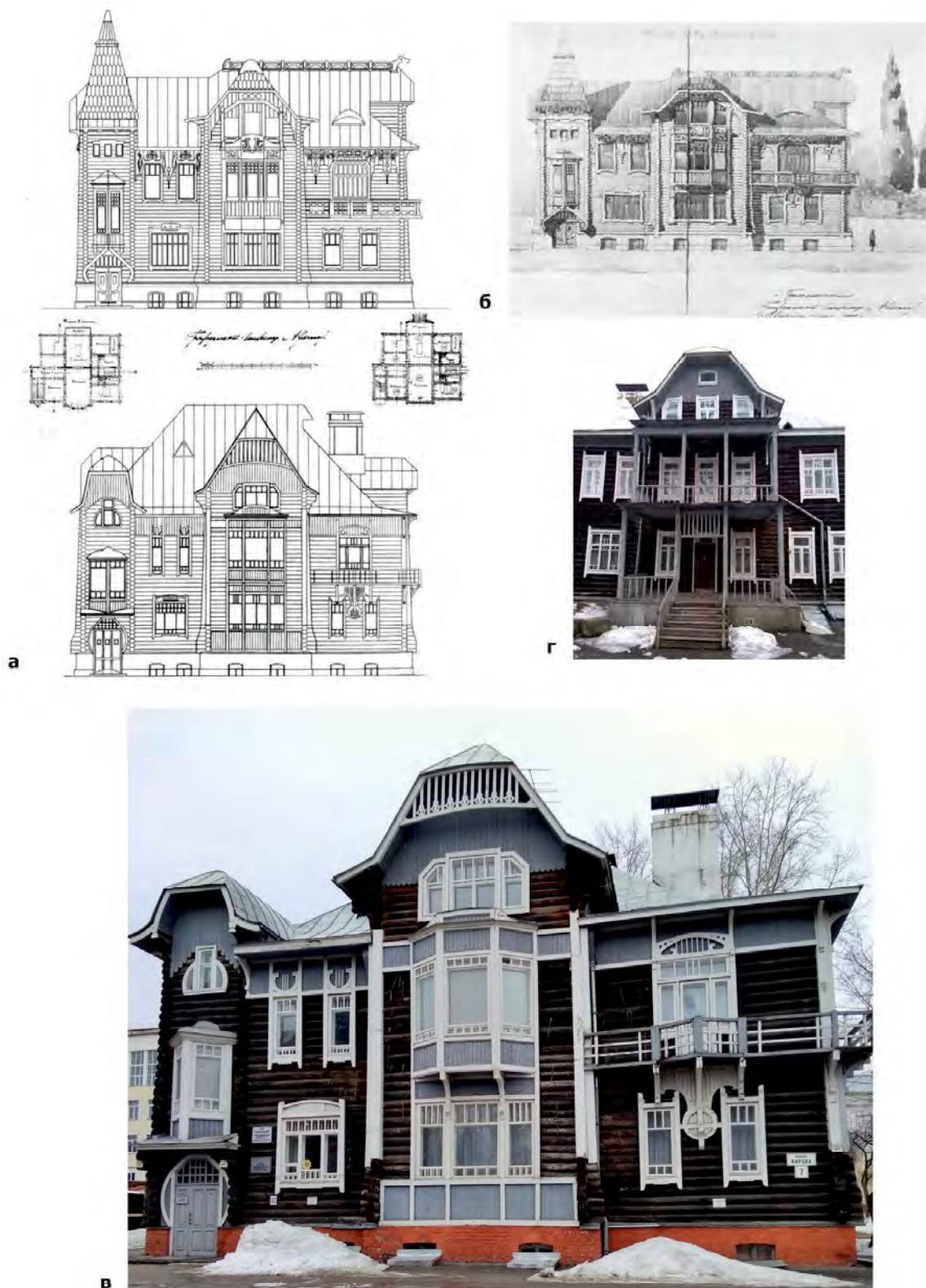
Ил. 1. Дом-особняк архитектора А.Д. Крячкова в Томске: а — графическая реконструкция первоначального и итогового проектов: главный фасад, планы 1-го и 2-го этажей. По: [Залесов, 2004, рис. 36]; б — фотокопия листа из первоначального проекта, 1909 г. (URL: http://news.ngs.ru/articles/50186801/ ); в — главный фасад; г — дворовой фасад. Снимки автора
